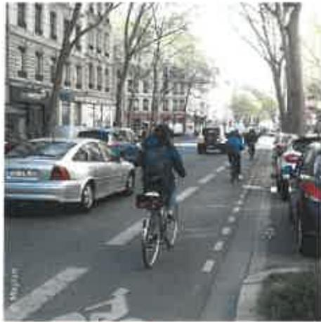
La largeur minimale d'une bande cyclable est de 1,50 m hors marquage. Une largeur de 2 m est préférable pour permettre le dépassement si le flux de cyclistes est significatif.
