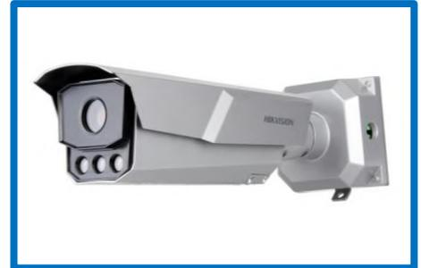
Cette caméra est équipée d'un OCR embarquée. Elle est donc apte à être utilisée pour le RAPI, conformément à la loi (Plaques d'immatriculations stockées dans la caméra (5000 u) et pas dans un fichier extérieur. Cette caméra, capable de lire les plaques sur trois voies jusqu'à 120km/h sera utilisée route de grasse et à l'intersection route de la Siagne – route de Saint Vallier.
